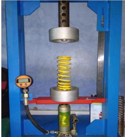
Gambar 4.5 Hasil akhir alat uji pegas
