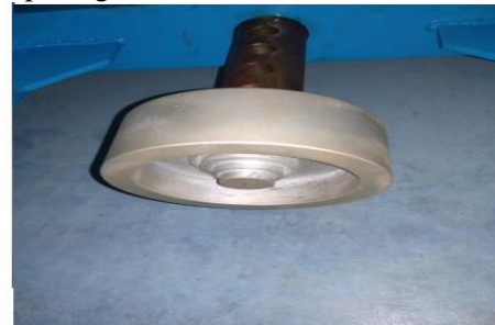
Gambar 4.2 Pemasangan upper base
