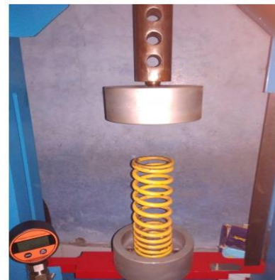
Gambar 4.4 Perakitan alat uji pegas
