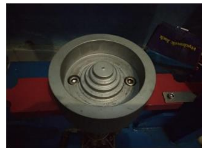
Gambar 4.1 Pemasangan bottom base
