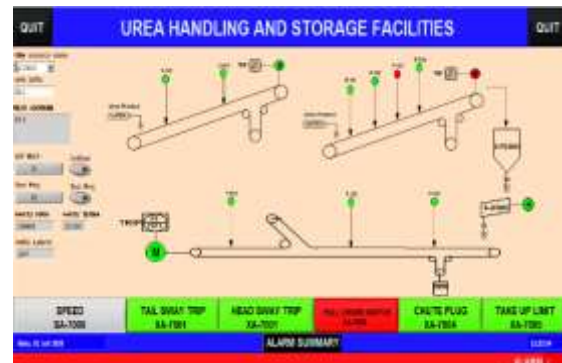
Gambar 8. Pengujian Indikator HMI pada Line 2 Conveyor
