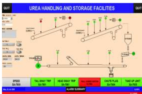
Gambar 7. Pengujian Indikator HMI pada Line 1 Conveyor
