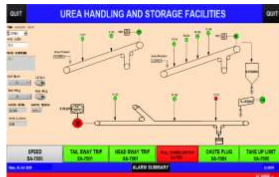
Gambar 9. Pengujian Indikator HMI pada Line 3 Conveyor
