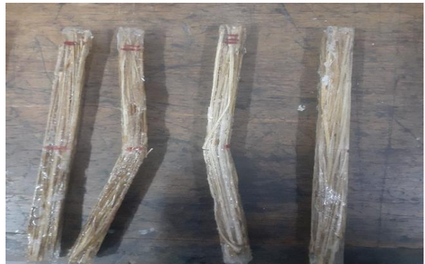
Gambar 5 Spesimen uji bending dengan perlakuan alkali serat salak dengan variasi perendaman 1 jam sampai dengan 4 jam
