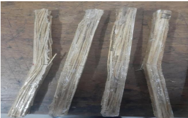
Gambar 4 Spesimen uji bending tanpa perlakuan alkali Serat Salak dengan variasi perendaman 1 jam sampai dengan 4 jam
