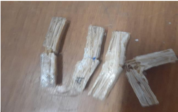
Gambar 2 Spesimen hasil uji impact tanpa perlakuan alkali Serat salak dengan variasi perendaman 1 jam sampai dengan 4 jam.
