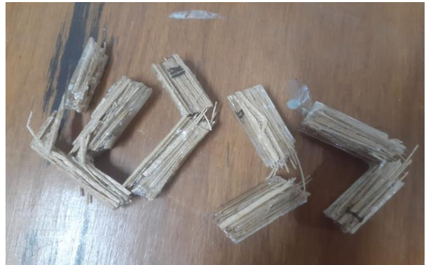
Gambar 3 Spesimen hasil uji impact dengan perlakuan alkali serat salak variasi perendaman 1 jam sampai dengan 4 jam.
