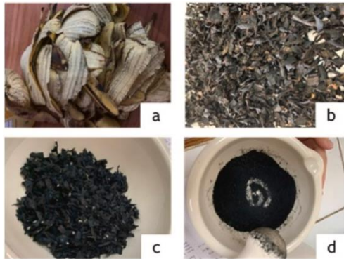
Gambar 3. Proses karbonisasi (a) kulit pisang, (b) kulit pisang setelah dikeringkan, (c) karbon aktif setelah karbonisasi, dan (d) karbon aktif setelah dihaluskan.
