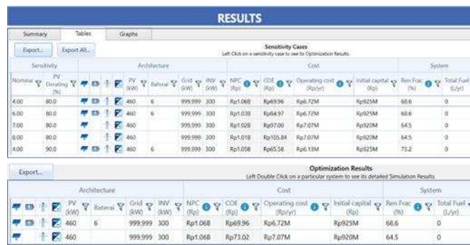
Gambar 6. Hasil simulasi konfigurasi sistem SPKLU dari optimasi perangkat lunak HOMER.
