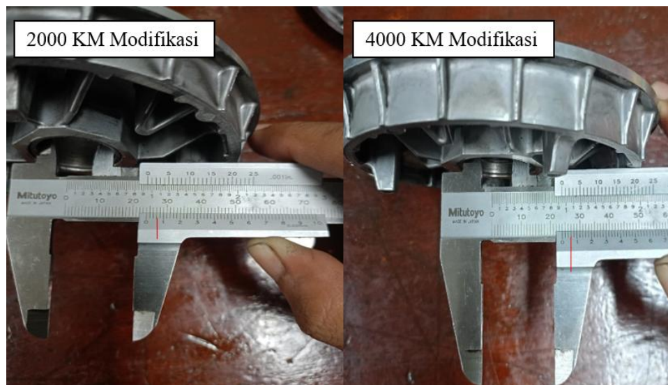
Gambar 5. Pengukuran diameter bushing modifikasi
