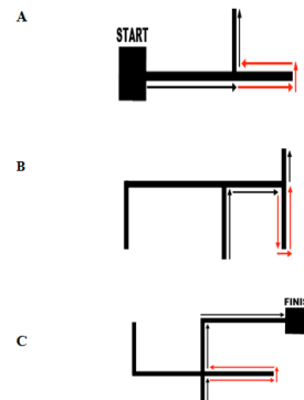
Gambar 8. Blok-blok saat robot melakukan mapping untuk prioritas kanan.
