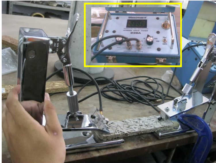
Gambar 1 Pengujian stress wave velocity menggunakan Metriguard 239A.
