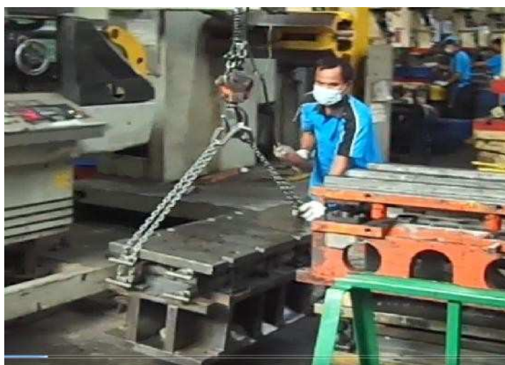
Gambar 4. Implementasi SMED pada Pergantian Dies (Sumber : Dokumen Pribadi)
