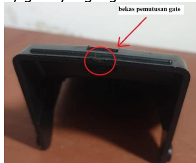
Gambar 2. Gate pada produk perangkap tikus mekanik plastik
