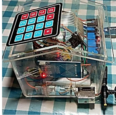
Gambar 6. Pengujian Proses Kerja Solenoid untuk Membuka Pintu
