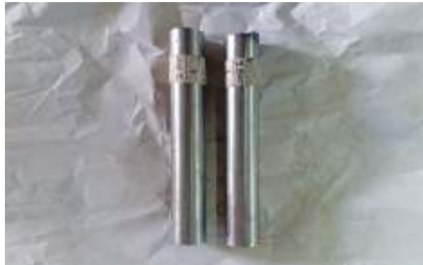
Gambar 2. Material Baja ST 42 yang sudah di potong
