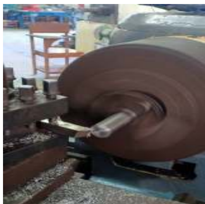
Gambar 3 Proses meratakan permukaan pada baja ST 42
