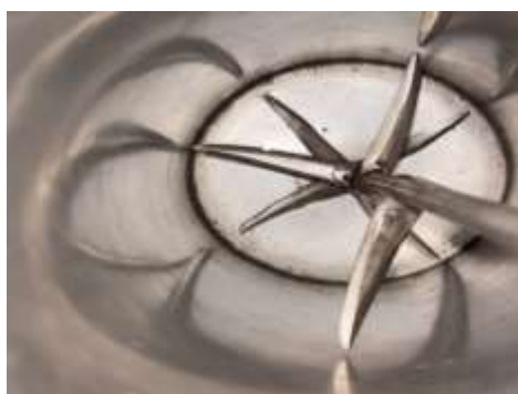
Gambar 3. Bilah Pengaduk dengan Sistem Pencacah
