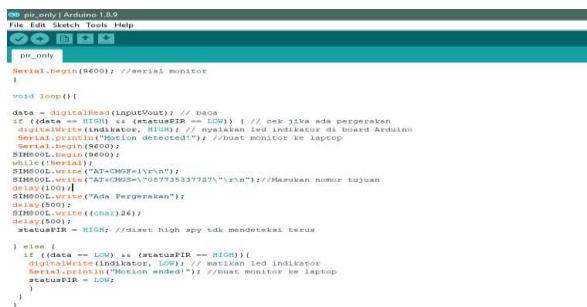
Gambar 15. Listing Pengujian Arduino Dengan Gprs Shield
