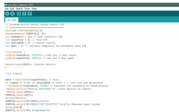
Gambar 13. Listing Pengujian Arduino Uno Dengan Sensor PIR
