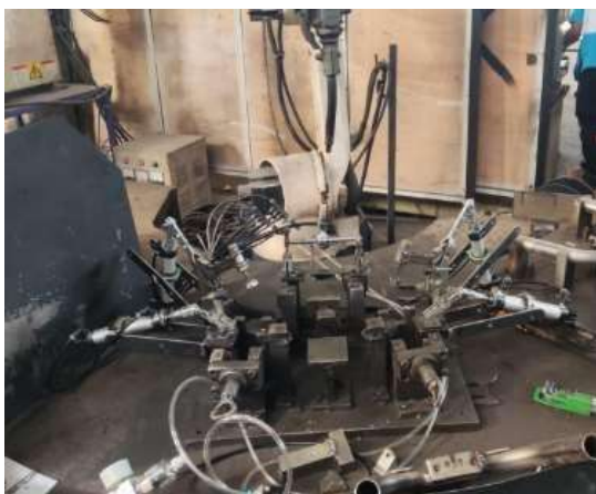
Gambar 7. Jig Welding yang sudah final
