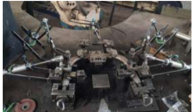
Gambar 8. Proses pemasangan rear tube
