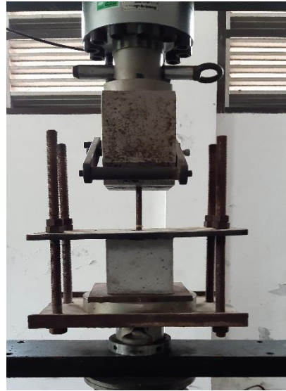
Gambar 5. Uji Tegangan Lekat dengan Pull Out
