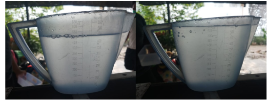
Gambar 17. Uji valve air 9 detik
