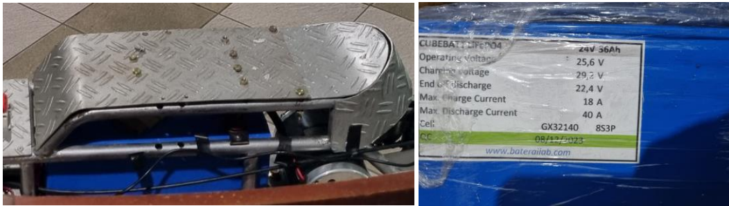
Gambar 6. Baterai LiFePO 4 24V/36Ah pada Otoped
