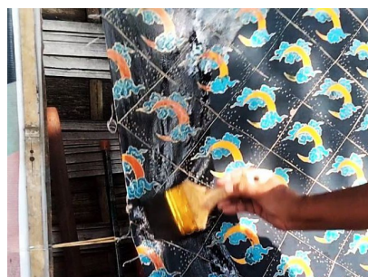
Gambar 6. Proses Penguncian Warna
