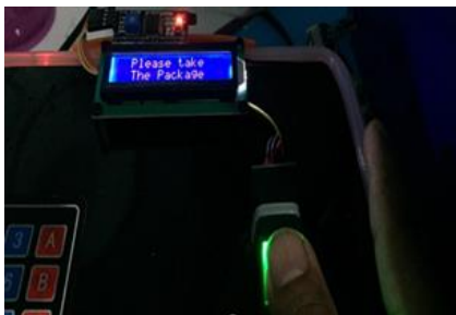
Gambar 9. Proses pembacaan sidik jari oleh fingerprint
