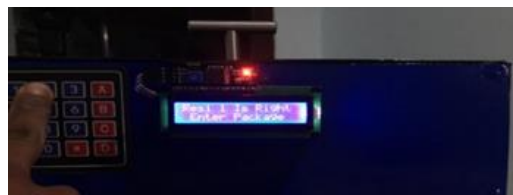
Gambar 5. Tampilan LCD ketika resi benar
