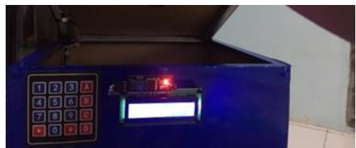
Gambar 6. Pintu 1 terbuka ketika resi benar
