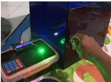
Gambar 8. Pintu 2 tidak bisa dibuka jika salah password
