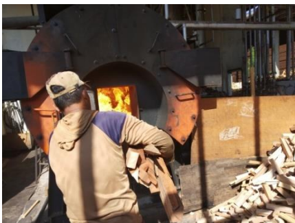
Gambar 2. Proses pembakaran untuk pengeringan kayu
