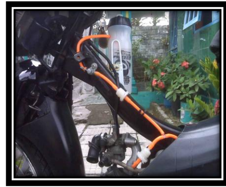
Gambar 3. Penempatan Water injection pada Sepeda Motor
