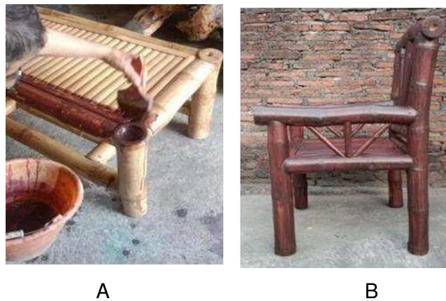
Gambar 8. A. Pemberian warna dasar pada permukaan produk bambu dengan larutan lem voc dan pigmen dan, B. hasil yang sudah didasari
