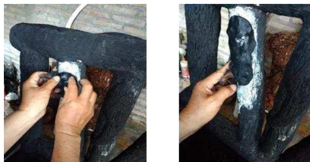
Gambar 9. Teknik ukir tempel aluminium clay sintetik pada permukaan bambu
