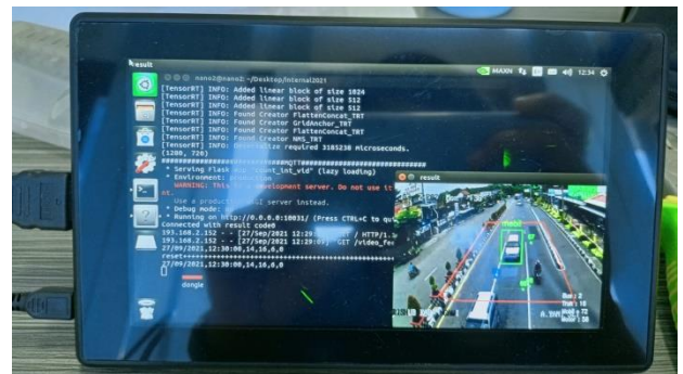
Gambar 5. Tampilan LCD saat proses pendeteksi dan klasifikasi berlangsung
