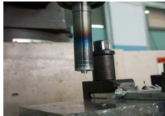
Gambar 2.1 Tool Pin yang digunakan pada pengelasan FSW
