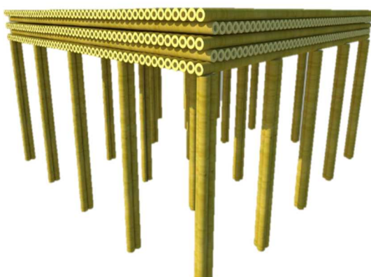
Gambar 4 Perkuatan Cerucuk dan 5 lapis matras bambu
