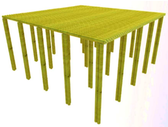
Gambar 2 Perkuatan Cerucuk dan 1 lapis matras bambu
