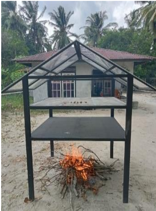
Gambar 4. Pengeringan teripang menggunakan alat pengering hybrid.
