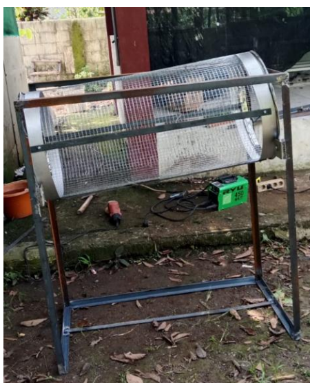
Gambar 12. Mesin pengayak maggot manual berbasis pedal
