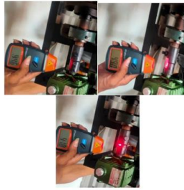
Gambar 9. Proses pengujian kecepatan putaran
