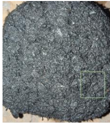
Gambar 10. Hasil dari proses pembriketan variasi pulley 2 inci
