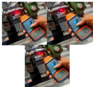
Gambar 11. Proses pengujian kecepatan putaran
