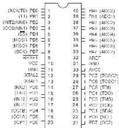
Gambar 1 Susunan pin (kaki) Mikrokontroler Atmega8535
