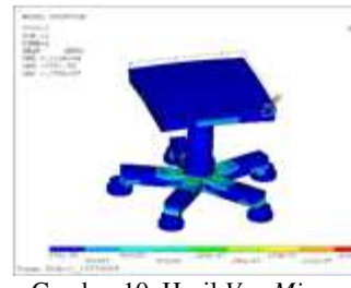
Gambar 10. Hasil Von Mises Stress Beban 135 kg.f
