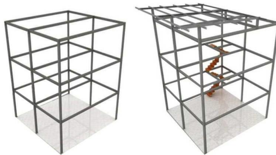
Gambar 12. Objek studi menerapkan struktur rangka dengan material besi WF dimensi 150x75mm Sumber: Dokumentasi Pribadi, 2023
