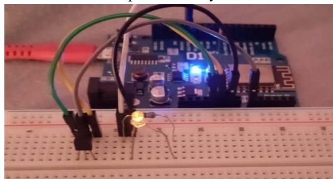
Gambar 8. Kondisi lampu LED menyala pada device IoT.
