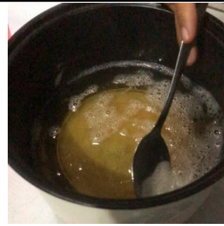
Gambar 10. Proses penghilangan busa setelah larutan berubah menjadi bening (Foto : Linda, 2024)
