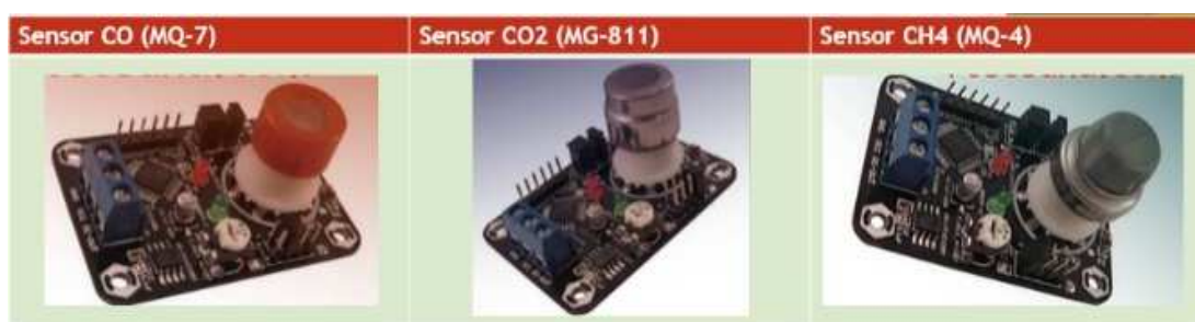
Gambar 1. Foto modul sensor gas berbasis Arduino untuk pengukuran konsentrasi gas CO, CO 2 dan CH 4 dalam luaran produk sintesis Fischer-Tropsch
