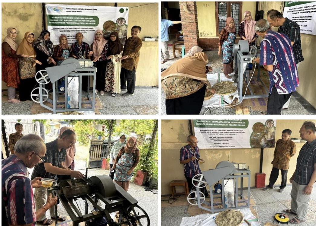
Gambar 2. Introduksi (kiri atas), uji coba (kanan atas) dan pelatihan (kiri bawah) penggunaan TTG alat perajang kerupuk di mitra IRT” Rambak Eco” serta irisan kerupuk yang dihasilkan (kanan bawah)
