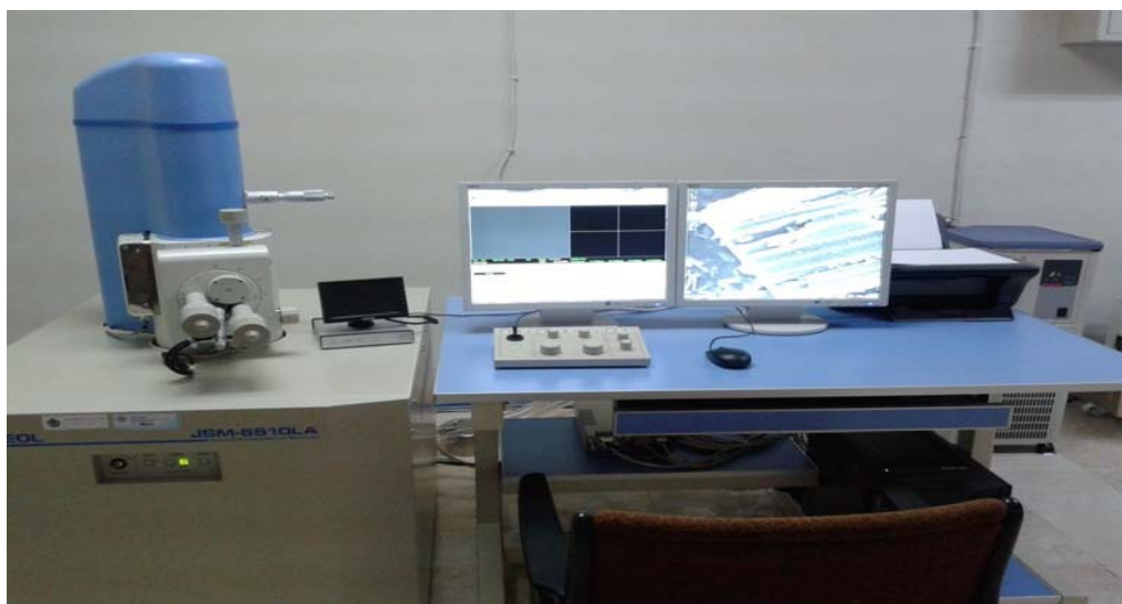
Gambar 2 Mesin pengamatan SEM dan analisa EDS di Laboratorium Penelitian dan Pengujian Terpadu, Universitas Gadjah Mada
