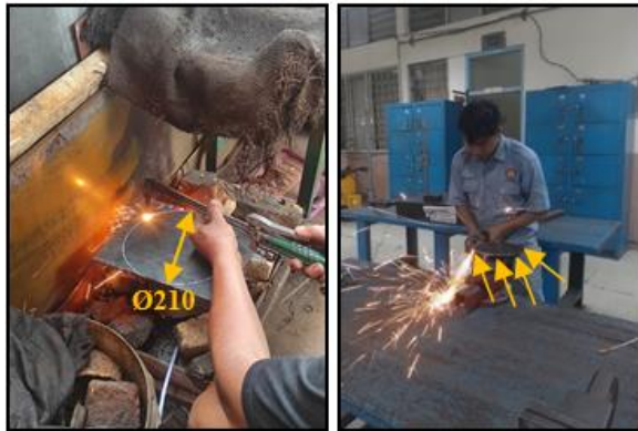
Gambar. 6 Pemotongan Plat Dudukan Magnet clutch menggunakan laser (kiri), dan proses abramping untuk sudut tepi yang kasar menggunakan gerinda
