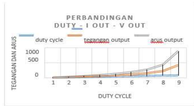
Gambar 12. Kurva pengaruh duty cycle terhadap arus output dan tegangan output
