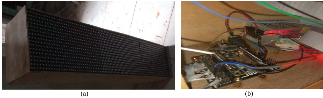
Gambar 7. Panel pengendali papan informasi jadwal shalat (a) tampak luar (b) rangkaian elektronik di dalamnya.
