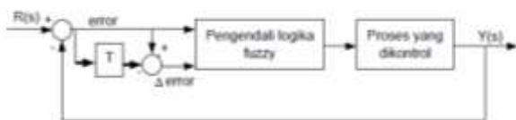
Gambar 4. Sistem loop tertutup dengan pengendali fuzzy
