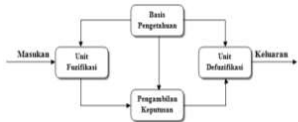
Gambar 5. Struktur dasar pengendali fuzzy [9]
