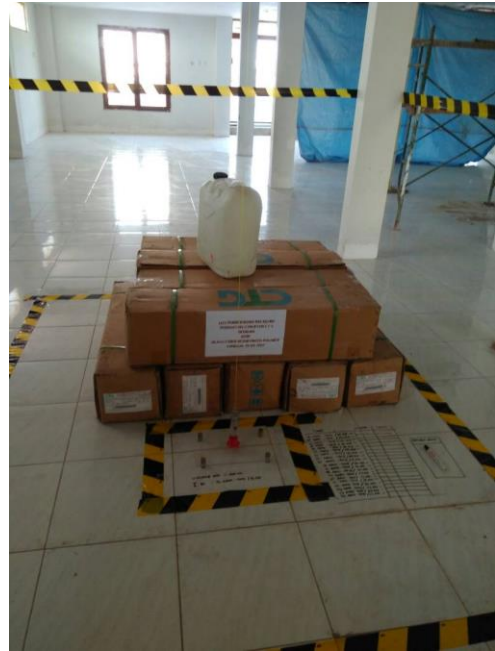
Gambar4: uji beban manual dengan bahan paking FRP seberat 400 kg.
