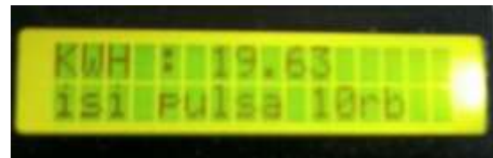
Gambar 6. Tampilan Layar LCD saat Pengisian Voucher Pulsa saat Kode yang Dimasukan Benar ( Valid ) atau Berhasil
