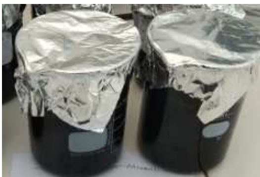
Gambar 5 Perendaman karbon aktif dengan aktivator H 2 SO 4
