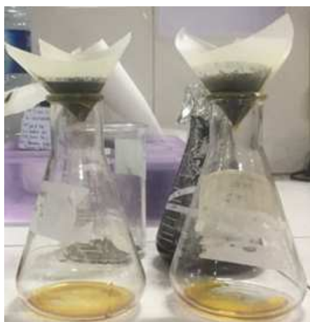
Gambar 9 Penyaringan karbon aktif dan minyak jelantah
