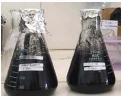
Gambar 8 Perendaman karbon aktif pada minyak jelantah
