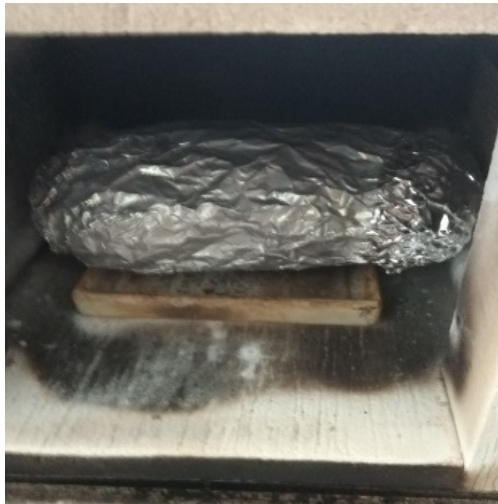
Gambar 3 Karbonisasi ampas tebu didalam furnace
