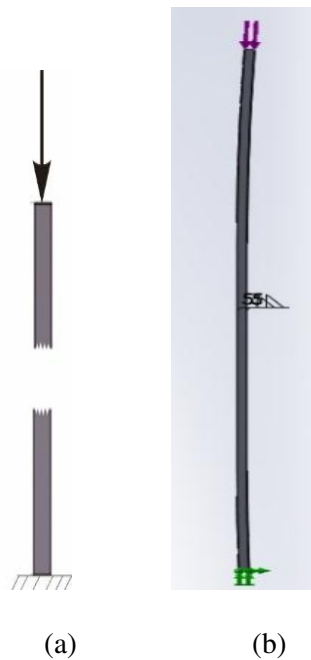
Gambar 6. Pembebanan yang diberikan pada tiang utama, (a) sketsa (b) model FEM.
