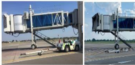
Gambar 2. Penempatan Pushback Car Yang Tidak Sesuai Di Apron Bandar Udara Internasional Adi Soemarmo
