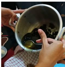
Gambar 4. Penyaringan Minyak Jelantah yang Telah Didiamkan dengan Arang Selama 24 Jam
