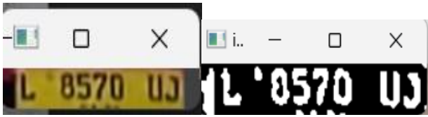
Gambar 6. Plat Nomor kendaraan yang sudah diekstraksi menggunakan metode K- Nearest Neighbors (KNN)
