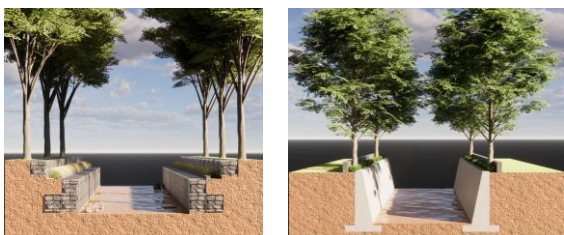
Gambar 2: Contoh implementasi retaining wall tahan banjir sebagai alat pengukur debit air
