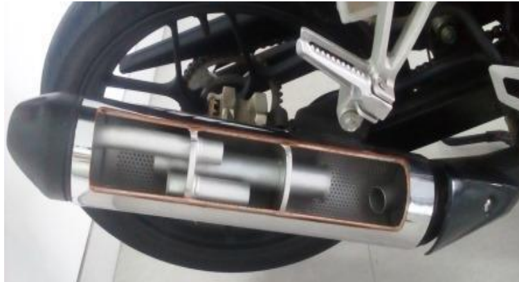
Gbr.2. Sekat ruang resonansi sepeda motor
